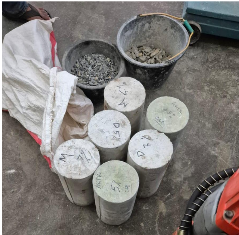
Gambar L. 6 Pemeriksaan Beton Setelah Perendaman
