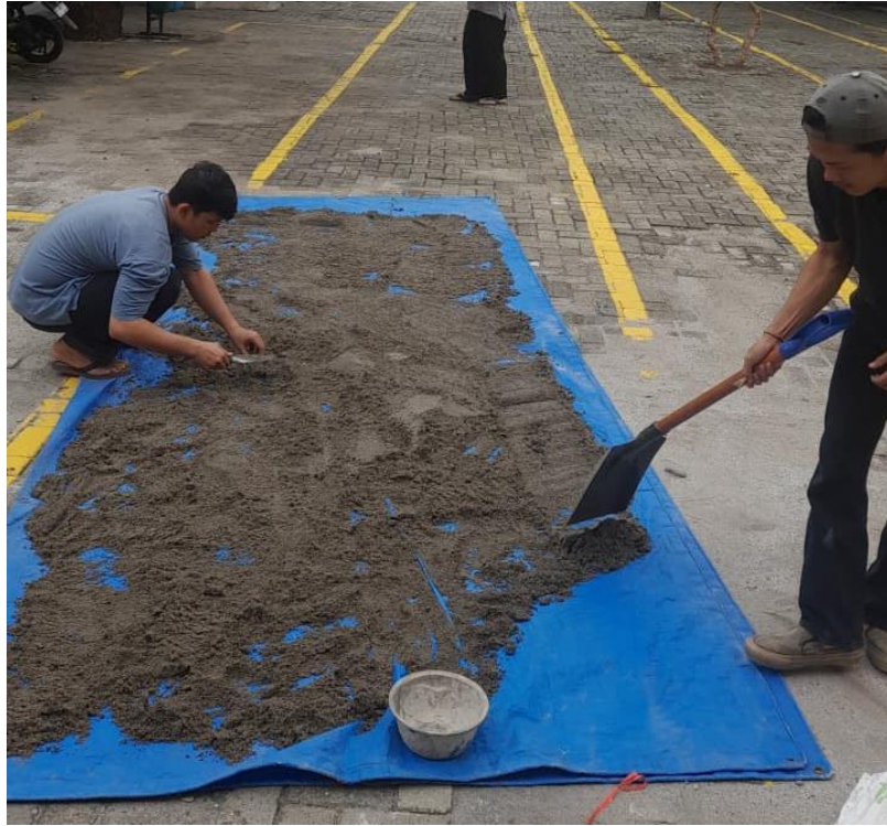
Gambar L. 5 Pemeriksaan Agregat Halus
