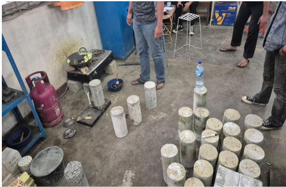
Gambar L. 7 Pemeriksaan Benda Uji Sebelum Di Keeping
