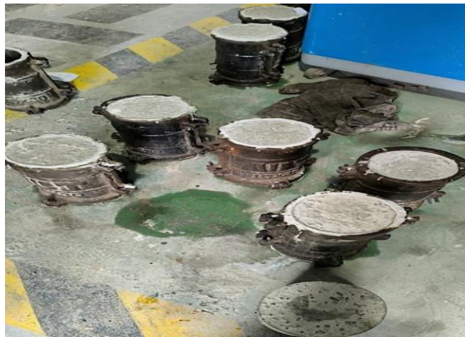
Gambar L. 9 : Benda uji beton kering dalam cetakkan
