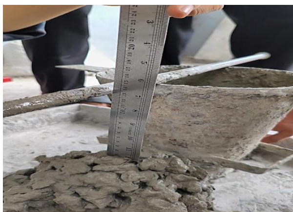
Gambar L. 4: Pengujian nilai slump
