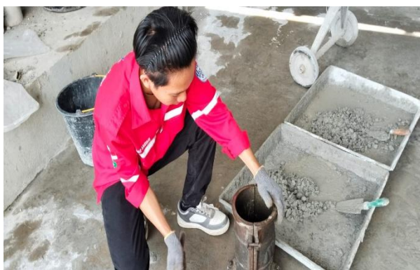
Gambar L. 5 : memasukkan benda uji kedalam cetakkan silinder
