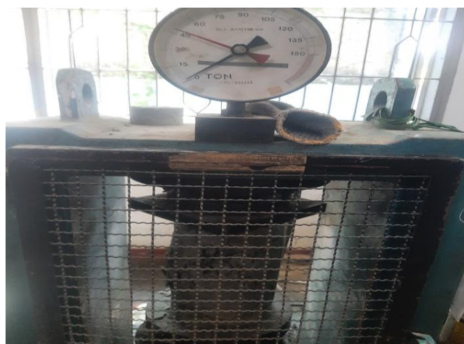
Gambar L. 8 : Pengujian kuat tekan beton
