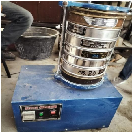
Gambar L.3 : Pengujian Analisa saringan
