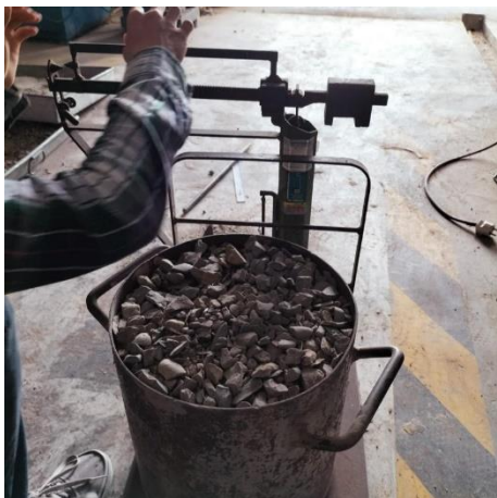
Gambar L.5 : Pengujian Berat isi agregat
