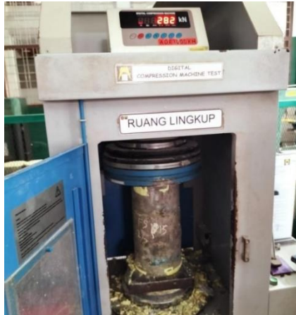
Gambar L.7 : Pengujian Kuat tekan
