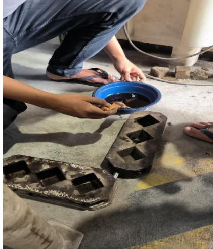
Gambar 4. Memberi oli pada cetakan
