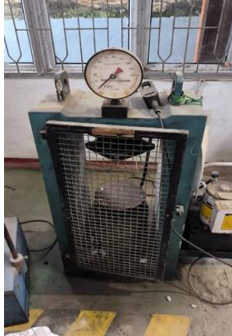
Gambar 3.26: Mesin uji kuat tekan
