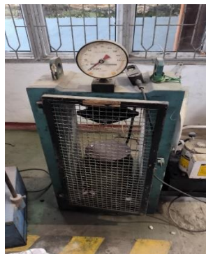
Gambar 3.19: Mesin uji kuat tekan.
