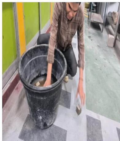
Gambar 9. Mengeluarkan benda uji dari perendaman
