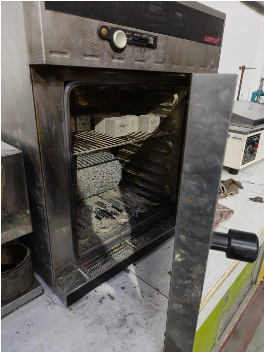
Lampiran 10. Uji Porositas Beton Pori
