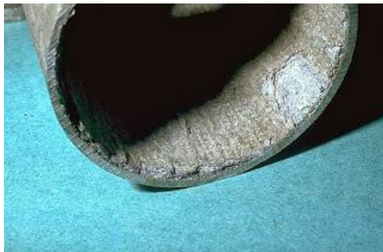
Gambar 2.5 Korosi Batas Butir ( Intergranular ) (Utomo, 2012)
