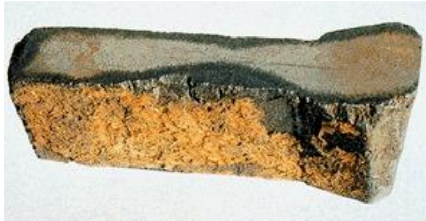
Gambar 2.4 Korosi Serangan Selektif(Utomo, 2012)
