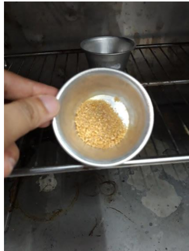
Gambar 22. Endapan di masukan ke dalam oven dengan suhu 120^{\circ}\text{C} .
