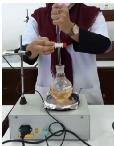
Gambar 25. Dititrasi dengan larutan NaOH 0,05 N
