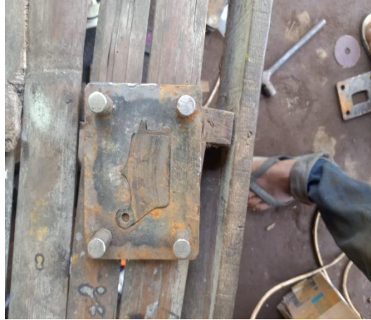
Gambar 3. 41 Memasukan plat kedalam cetakan
