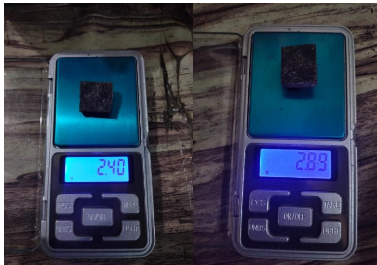
Gambar 3. 52 Massa akhir benda uji komposisi 1
