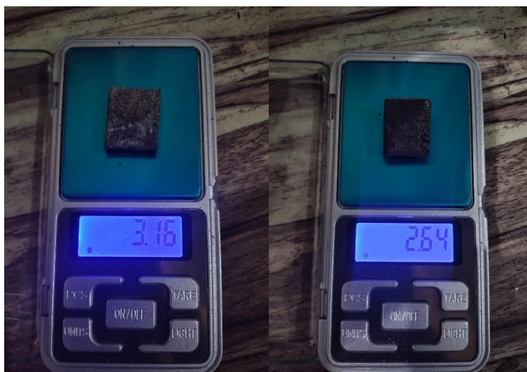
Gambar 3. 54 Massa akhir benda uji komposisi 3
