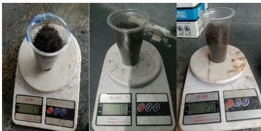
Gambar 3. 37 Serat ijuk dengan kanvas rem 1 17 gram, kanvas rem 2 18 gram dan kanvas rem 3 20 gram
