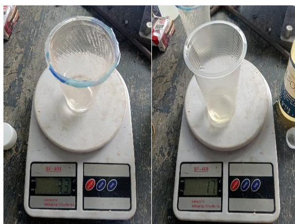
Gambar 3. 38 Resin dan katalis dengan kanvas rem 1 50 gram, kanvas rem 2 45 gram dan kanvas rem 3 40 gram dengan perbandingan 2:1
