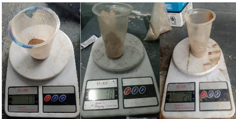
Gambar 3. 36 Serbuk cangkang kemiri dengan kanvas rem 1 17 gram, kanvas rem 2 18 gram dan kanvas rem 3 20 gram
