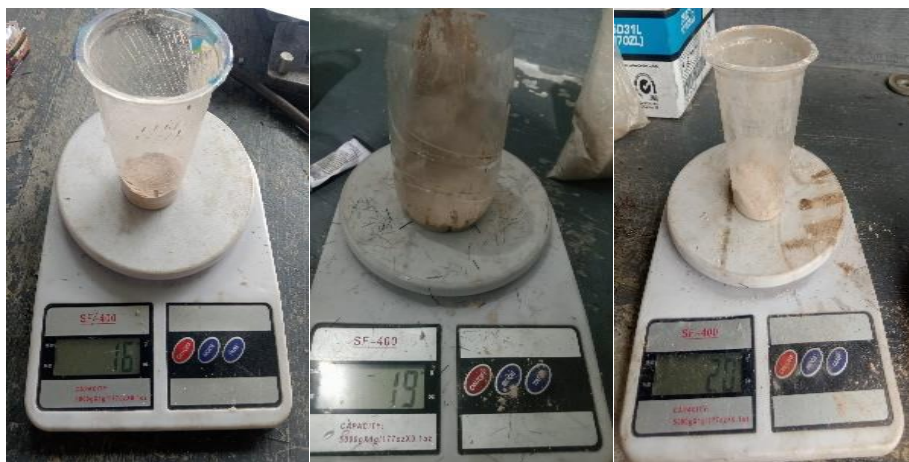
Gambar 3. 35 Serbuk barium sulfat dengan kampas rem 1 16 gram, kampas rem 2 19 gram dan kampas rem 3 20 gram
