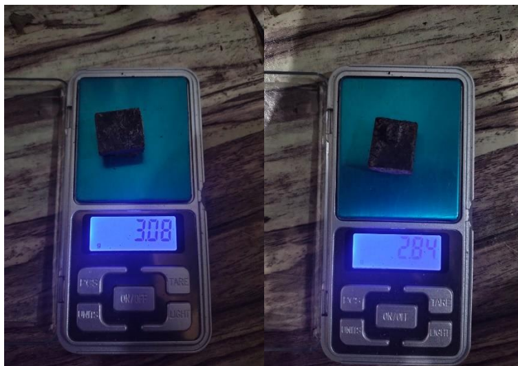
Gambar 3. 53 Massa akhir benda uji komposisi 2
