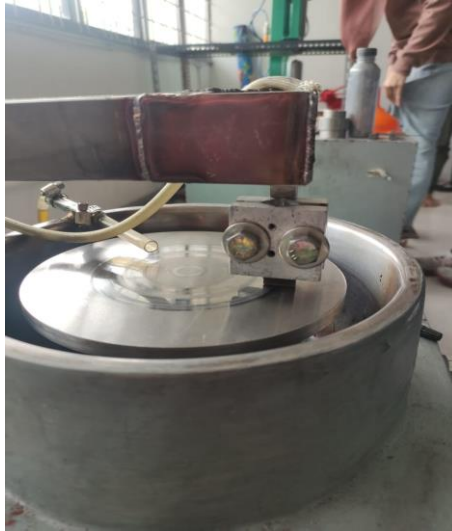
Gambar 3. 51 Pengujian benda uji pada mesin Tribometer pin on disc
