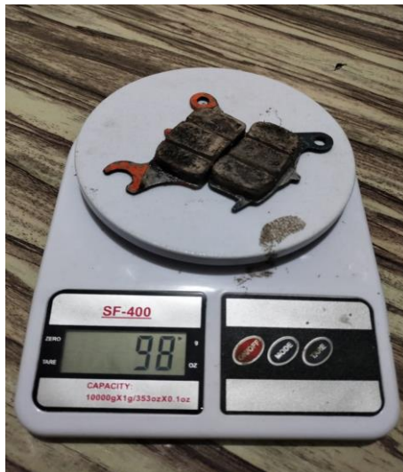
Gambar 3. 46 Kampas rem dengan massa yang sudah dikeringkan
