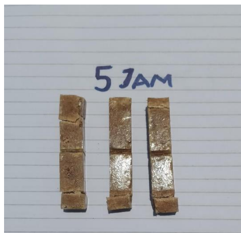
Gambar 4.15 Spesimen setelah di uji pada perendaman lima jam
