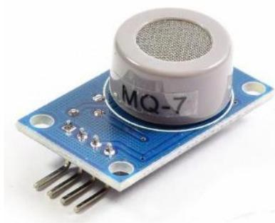
Gambar 2. 4 Modul Sensor MQ7
