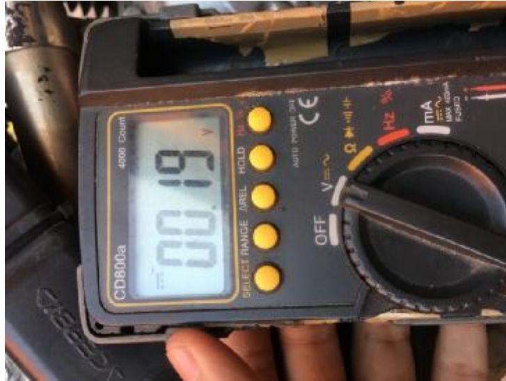
Gambar 4.3 Mengukur voltase pada alat pengisi daya handphone dalam keadaan idle dengan waktu 1 menit
