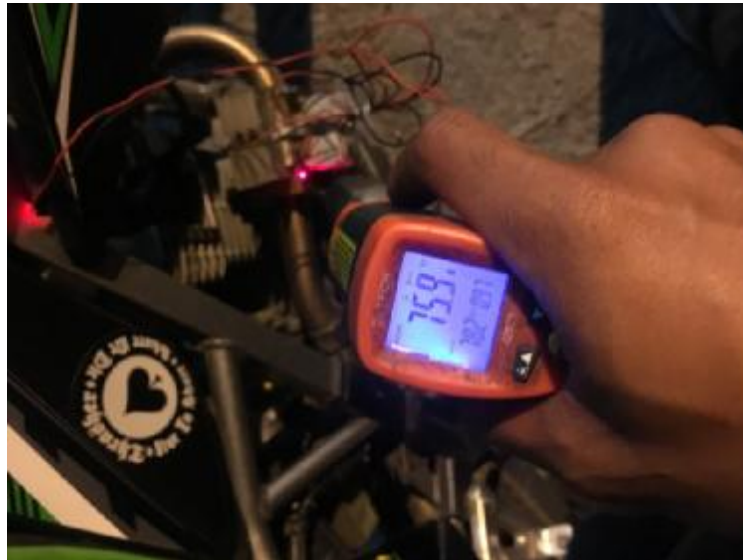
Gambar 4.35 mengukur temperatur kuningan dalam keadaan dijalankan 20 km/jam dengan waktu 6 menit
