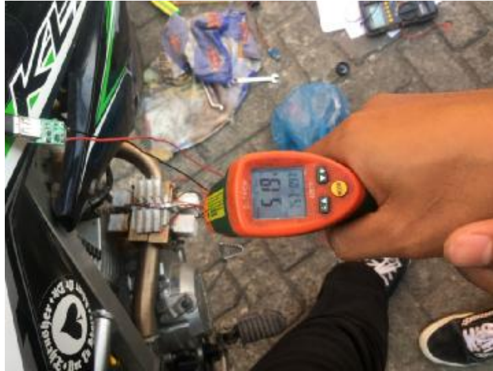
Gambar 4.29 mengukur temperatur kuningan dalam keadaan Idle dengan waktu 6 menit
