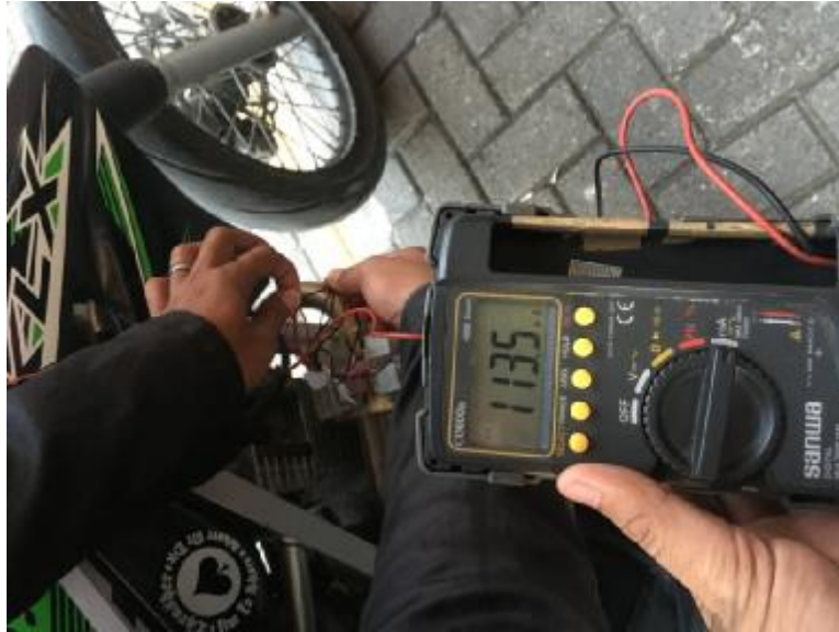
Gambar 4.19 mengukur Arus pada alat pengisi daya handphone dalam keadaan dijalankan 10 km/jam dengan waktu 3 menit
