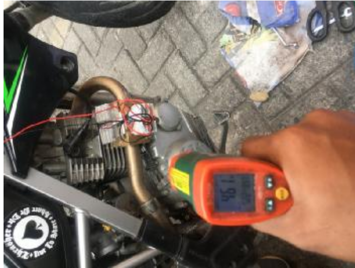
Gambar 4.11 mengukur temperatur kuningan dalam keadaan dijalankan 20 km/jam dengan waktu 1 menit
