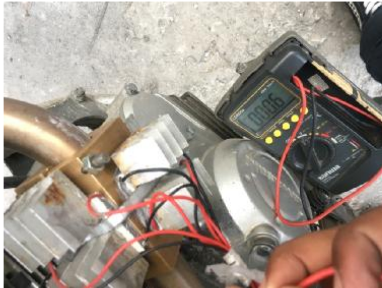
Gambar 4.18 mengukur Voltase pada alat pengisi daya handphone dalam keadaan dijalankan 10 km/jam dengan waktu 3 menit
