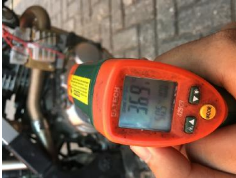
Gambar 4.5 Mengukur temperatur kuningan dalam keadaan idle dengan waktu 1 menit
