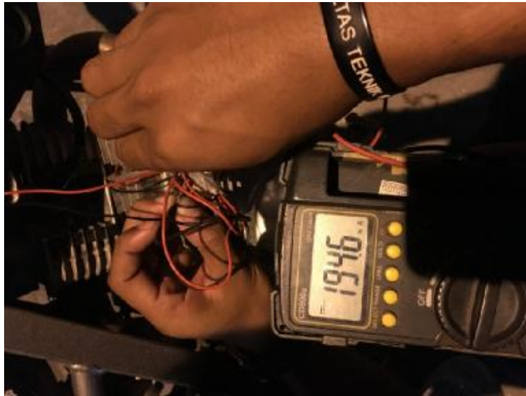
Gambar 3.25 mengukur Arus pada alat pengisi daya handphone dalam keadaan dijalankan 30 km/jam dengan waktu 3 menit
