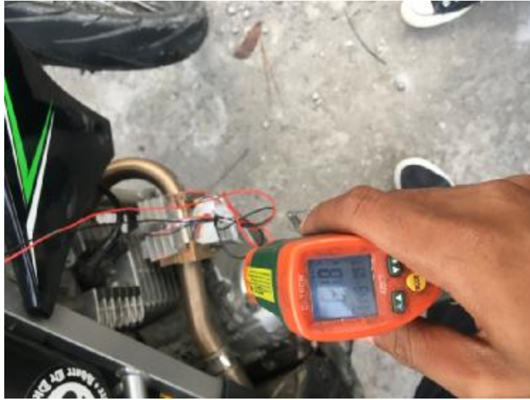
Gambar 4.23 mengukur temperatur kuningan dalam keadaan dijalankan 20 km/jam dengan waktu 3 menit
