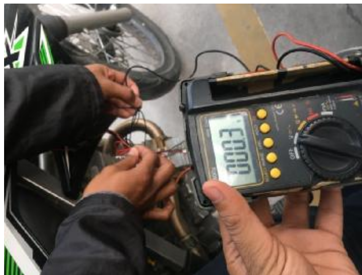
Gambar 4.6 mengukur Voltase pada alat pengisi daya handphone dalam keadaan dijalankan 10 km/jam dengan waktu 1 menit
