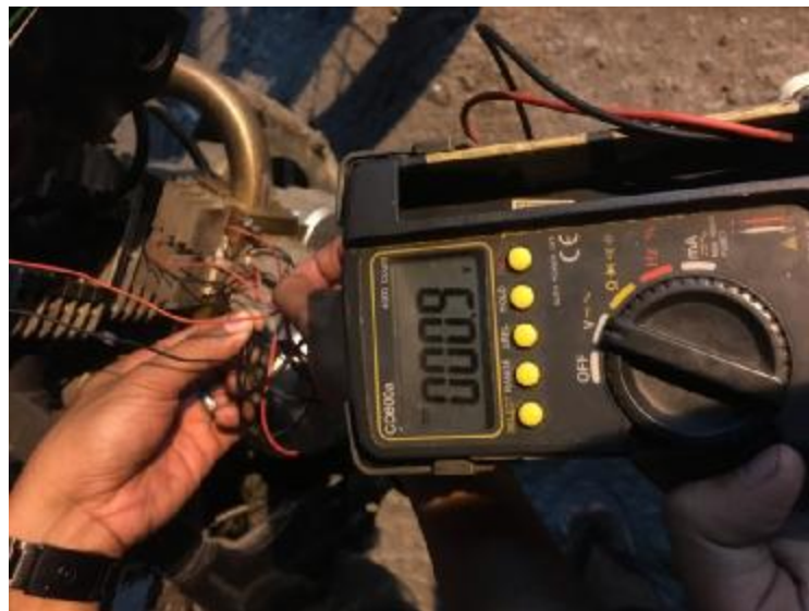
Gambar 4,30 mengukur Voltase pada alat pengisi daya handphone dalam keadaan dijalankan 10 km/jam dengan waktu 6 menit
