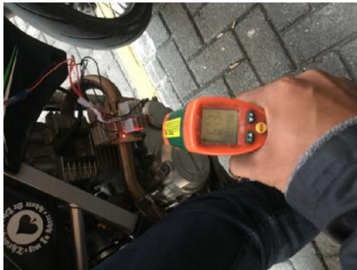
Gambar 4.20 mengukur temperatur kuningan dalam keadaan dijalankan 10 km/jam dengan waktu 3 menit
