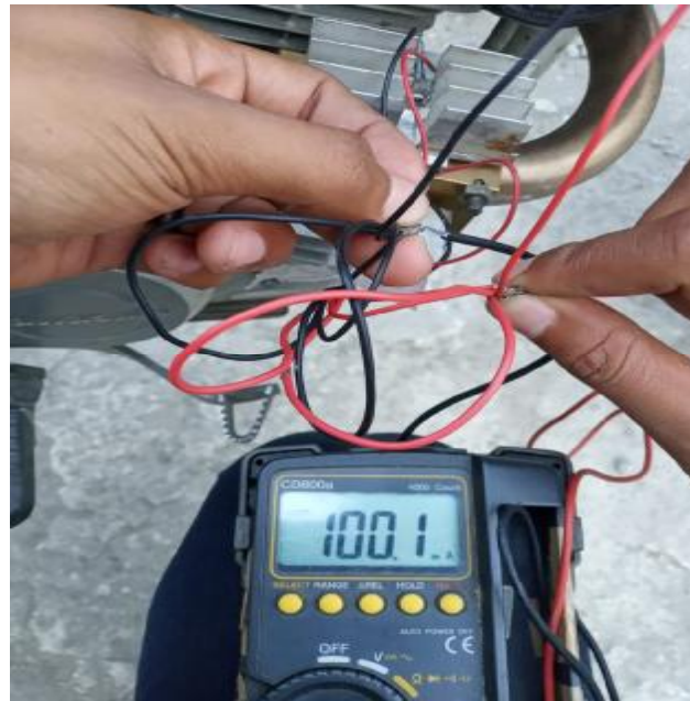
Gambar 4.10 mengukur Arus pada alat pengisi daya handphone dalam keadaan dijalankan 20 km/jam dengan waktu 1 menit
