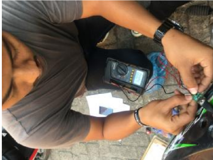
Gambar 4.27 mengukur Voltase pada alat pengisi daya handphone dalam keadaan idle dengan waktu 6 menit
