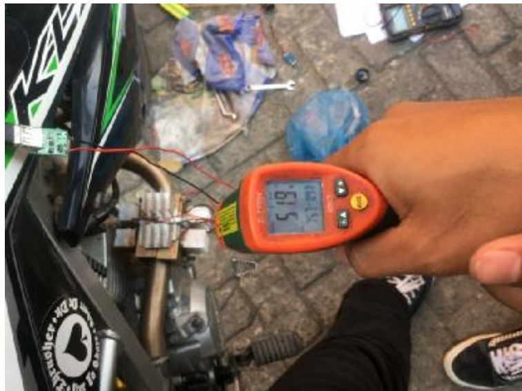
Gambar 4.14 mengukur temperatur kuningan dalam keadaan dijalankan 30 km/jam dengan waktu 1 menit
