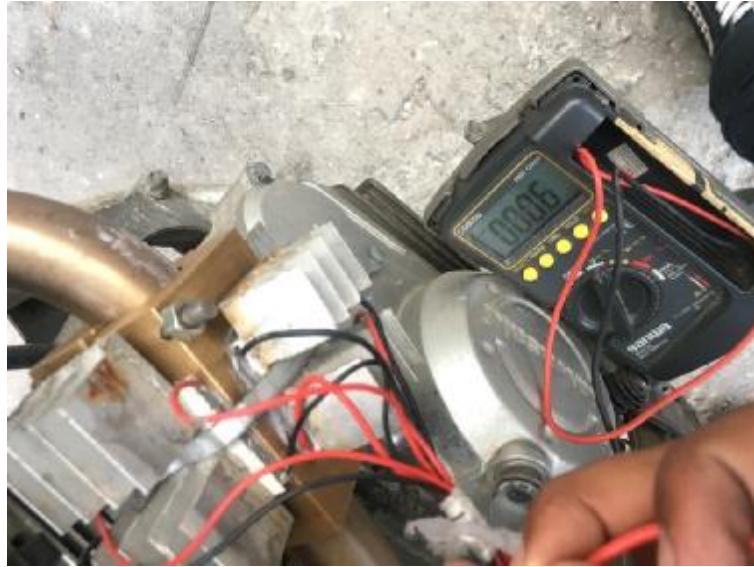
Gambar 4. 21 mengukur Voltase pada alat pengisi daya handphone dalam keadaan dijalankan 20 km/jam dengan waktu 3 menit
