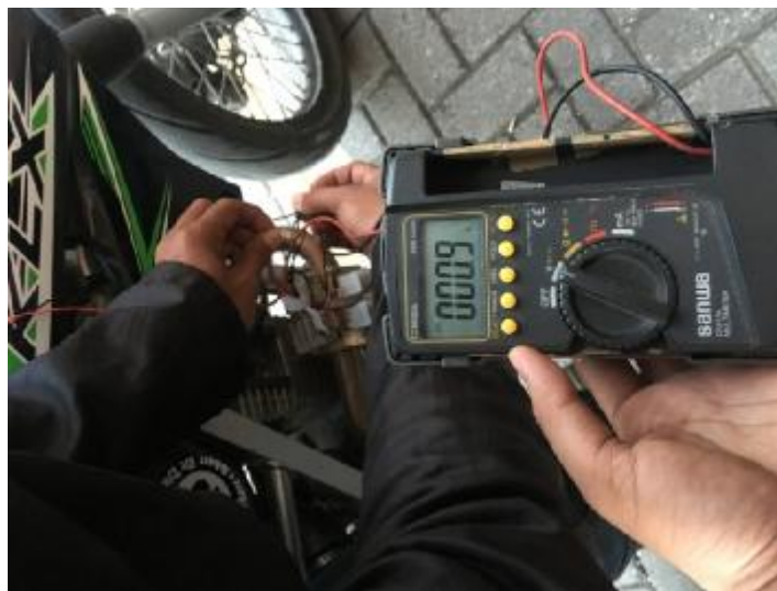
Gambar 4.24 mengukur Voltase pada alat pengisi daya handphone dalam keadaan dijalankan 30 km/jam dengan waktu 3 menit
