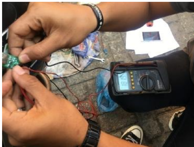
Gambar 4.34 mengukur Arus pada alat pengisi daya handphone dalam keadaan dijalankan 20 km/jam dengan waktu 6 menit
