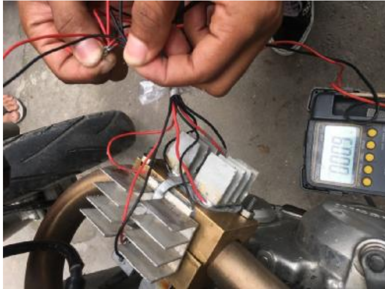
Gambar 4.33 mengukur Voltase pada alat pengisi daya handphone dalam keadaan dijalankan 20 km/jam dengan waktu 6 menit
