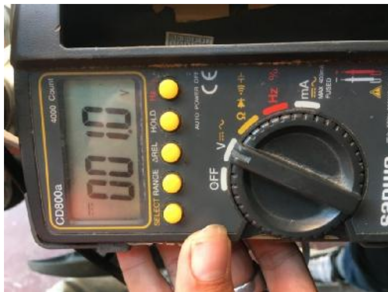
Gambar 4.36 mengukur Voltase pada alat pengisi daya handphone dalam keadaan dijalankan 30 km/jam dengan waktu 6 menit
