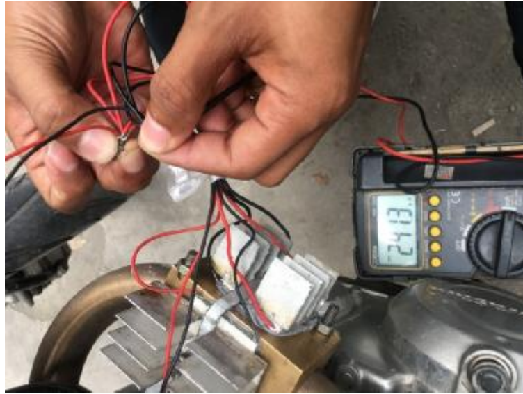
Gambar 4.37 mengukur Arus pada alat pengisi daya handphone dalam keadaan dijalankan 30 km/jam dengan waktu 6 menit
