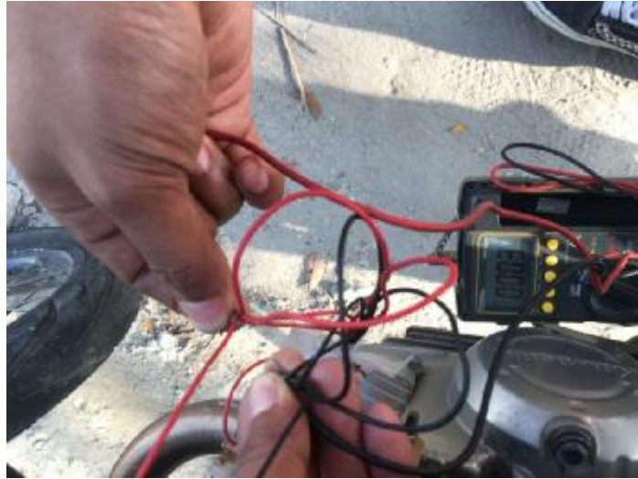
Gambar 4.9 mengukur Voltase pada alat pengisi daya handphone dalam keadaan dijalankan 20 km/jam dengan waktu 1 menit
