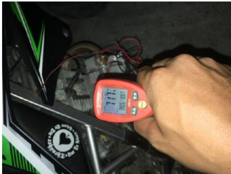
Gambar 4.32 mengukur temperatur kuningan dalam keadaan dijalankan 10 km/jam dengan waktu 6 menit
