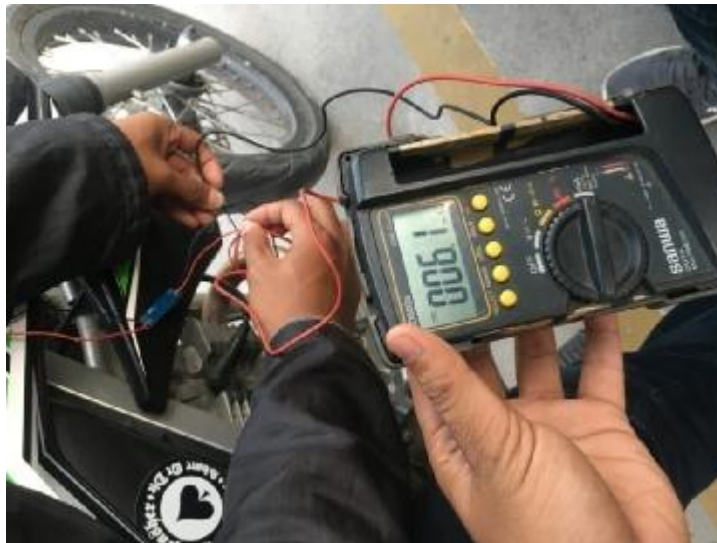
Gambar 4.4 Mengukur arus pada alat pengisi daya handphone dalam keadaan idle dengan waktu 1 menit
