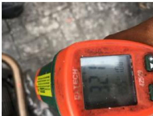
Gambar 4.2 Mengukur Temperatur Knalpot Sebelum diuji
