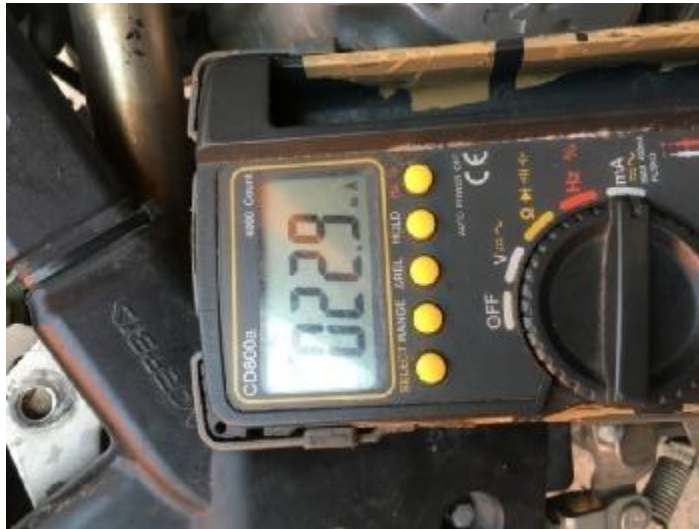
Gambar 4.7 mengukur Arus pada alat pengisi daya handphone dalam keadaan dijalankan 10 km/jam dengan waktu 1 menit
