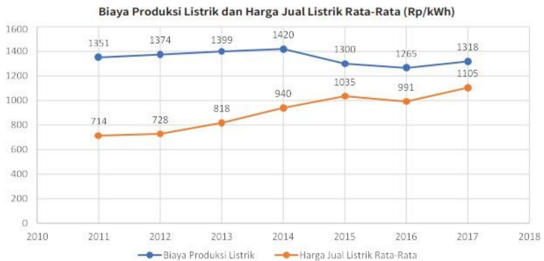
Gambar 1 Biaya produksi listrik dan harga jual listrik rata-rata. Biaya produksi listrik mencakup biaya pembangkitan dan biaya transmisi dan distribusi. Sumber: Statistik PLN.
