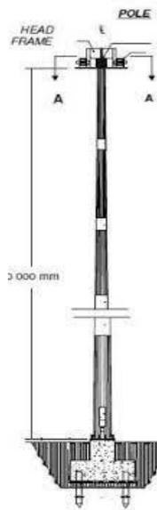
**Gambar 2.4** Tiang lampu tegak tanpa lengan
