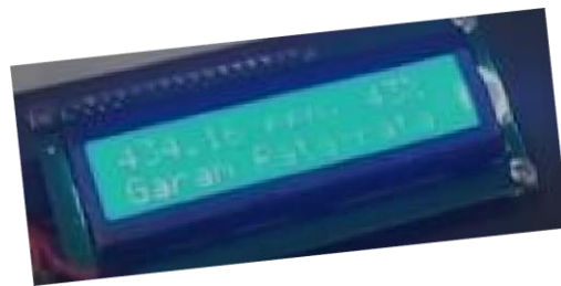
Gambar 4. 3 Tampilan Hasil Kadar Garam Pada LCD 12C
