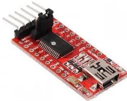
**Gambar 2. 14. FTDI USB Converter**
