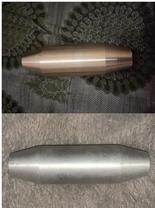
Gambar 4.1 pipa Resonator yang sudah jadi
