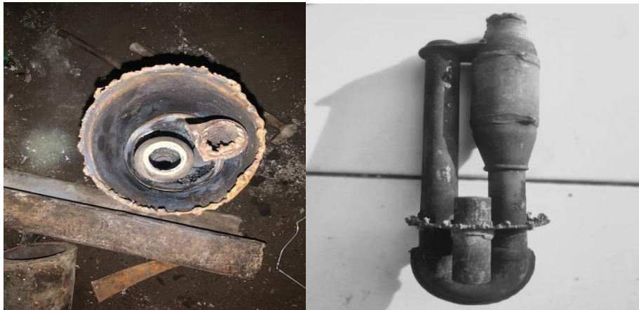
Gambar 3.6 proses pembelahan knalpot standar
