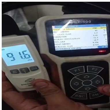
Gambar 4.5 pengujian kebisingan dan mengukur rpm mes
