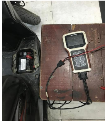
Gambar 4.4 menghubungkan Fi Scanner ke baterai
