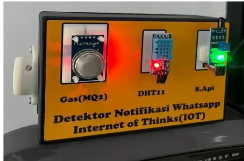
Gambar 4.3 hasil rakitan sistem
