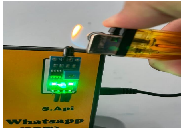
Gambar 4.9 pengujian sensor api
