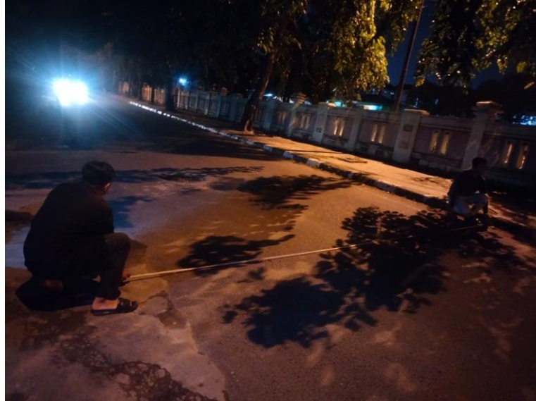
Gambar Pengukuran Lebar Jalan (Survey)
