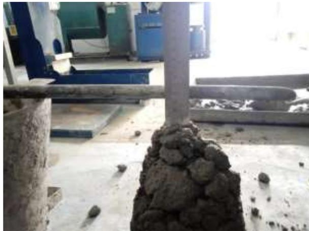
Lampiran 29 : Proses Pengujian *Slump Test*.
