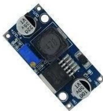
Gambar 2.3. Module Stepdown LM2596
