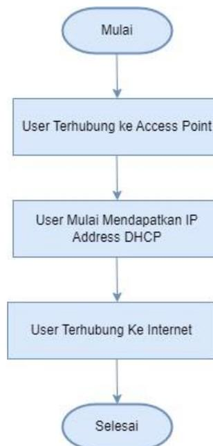
Gambar 3. 3 Flowchart sistem jaringan hotspot tanpa security ingin menggunakan internet dan melakukan autentikasi ke server hotspot.
