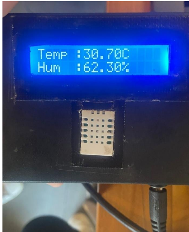
Gambar 4.4 Tampilan Hasil Nilai Suhu Pada LCD ( Liquid Crystal Display )
