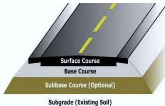
Gambar 2.1 : Lapisan perkerasan lentur
