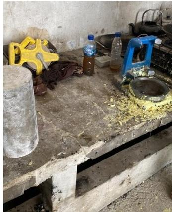
Gambar L. 11 Pemasangan Capping Pada Benda Uji
