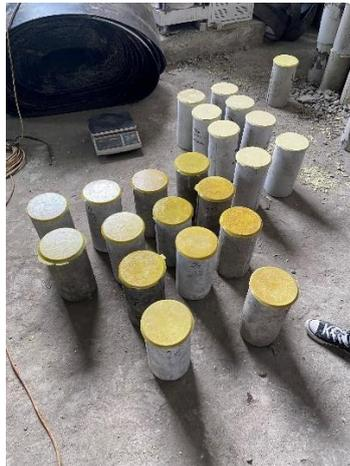
Gambar L. 12 Pemasangan Capping Pada Benda Uji
