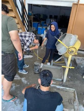
Gambar L. 7 Pengerjaan Rojok Pada Benda Uji
