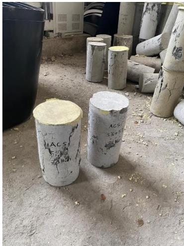
Gambar L. 14 Retakan Pada Benda Uji
