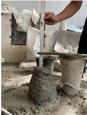
Gambar L. 8 Pengujian Slump
