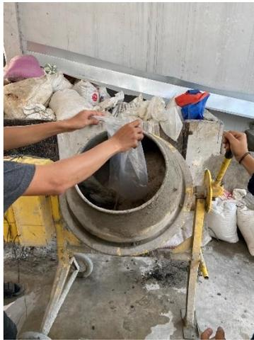
Gambar L. 5 Memasukan Bahan Pada Pembuatan Benda Uji
