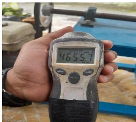
Gambar 4.1 pengukuran kecepatan pada motor penggiling
