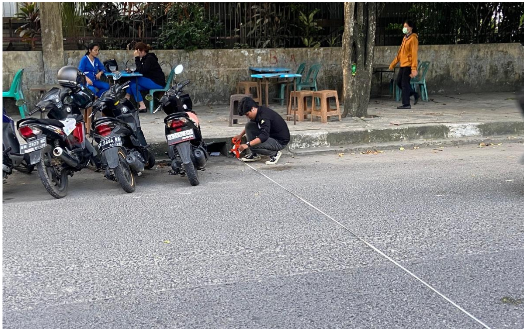
Gambar L. 1.4:Pengukuran Lebar Ruas Jalan Dokter Mansyur
