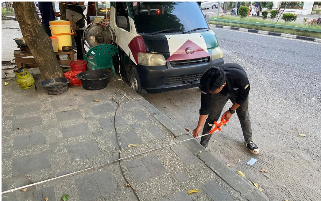
Gambar L. 1.6: Pengukuran Lebar Pendestrian di Ruas Jalan Dokter Mansyur
