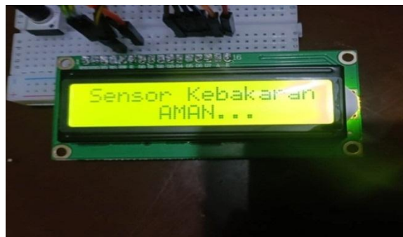
Gambar 4.10 Display dari layar LCD menunjukkan tidak adanya kebocoran
