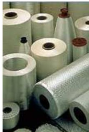
Gambar 2.12 Ilustrasi reinforcement pada komposit
