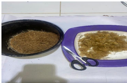
Gambar 4.4 pemotongan TKKS dan filter rokok
