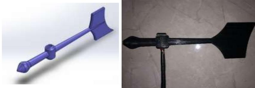
Gambar 4.8 Desain Sirip arah angin dan hasil pencetakan
