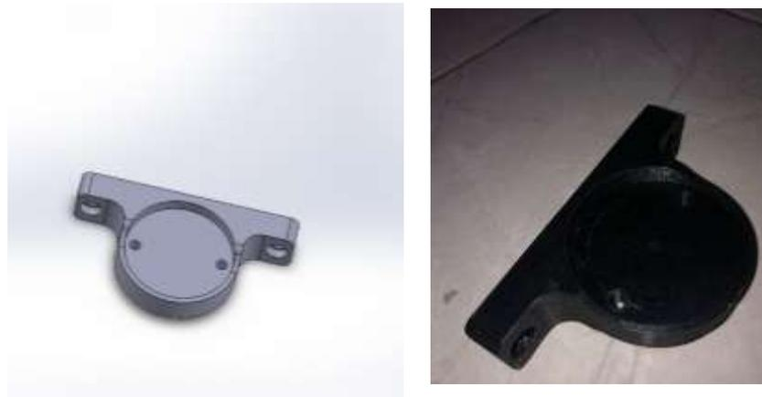
Gambar 4.7 Desain Breket housing/breket rumah sensor dan hasil pencetakan
