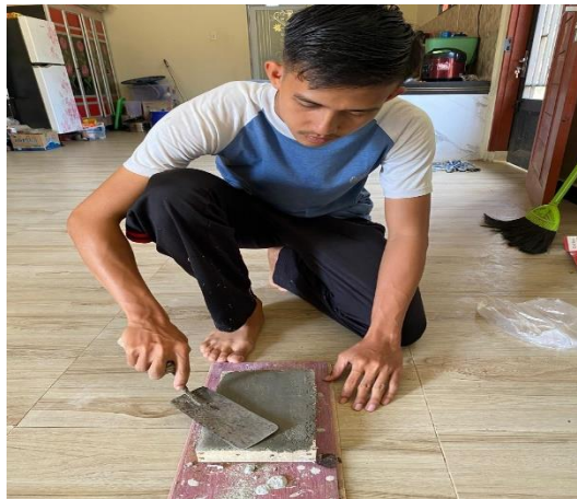
Gambar 4.9 Proses pencampuran semen pasir dan serat durian
