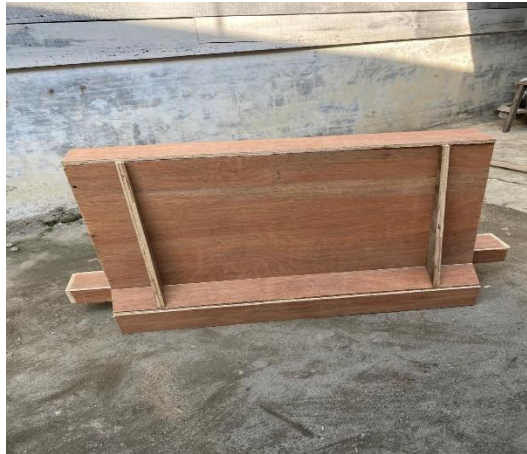
Gambar 4.2 Cetakan Road barrier
