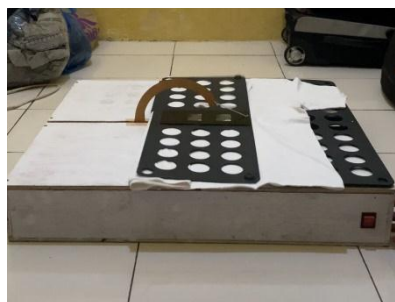
Gambar 4.18 Pelipat bergerak kiri ke kanan – Kaos pendek
