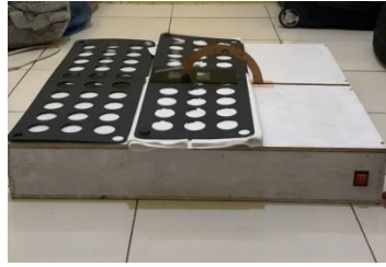
Gambar 4.19 Pelipat bergerak kanan ke kiri – Kaos pendek
