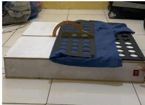
Gambar 4.21 Pelipat bergerak kiri ke kanan – Kemeja pendek
