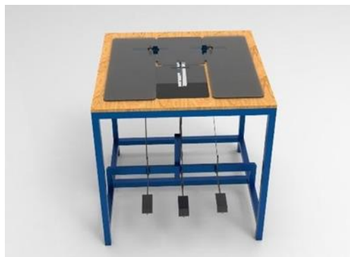
Gambar 2. 4 Pelipat Baju Menggunakan Pegas (Basuki, 2019)
