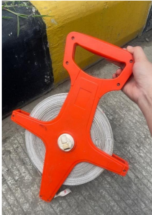
Gambar L.7 : Meteran gulung untuk mengukur jarak lokasi pengukuran ke sumber suara
