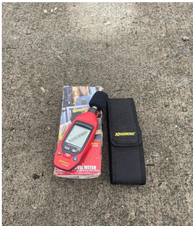
Gambar L.3 : Alat sound level meter mengukur intensitas kebisingan
