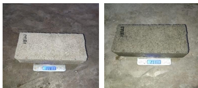
Gambar 4.34 hasil pengujian serap air sampel 3(3)
