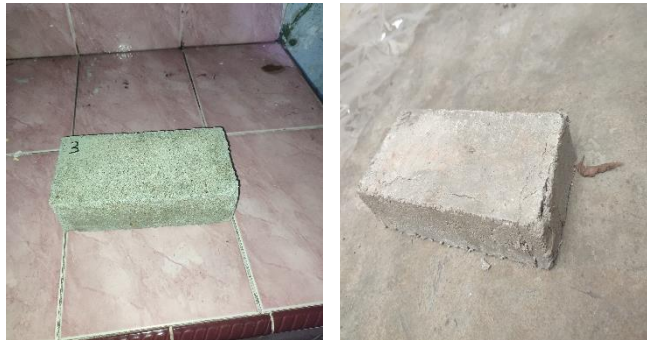
Gambar 4.25 Sampel 3(3) sebelum dan sesudah di Uji Tekan
