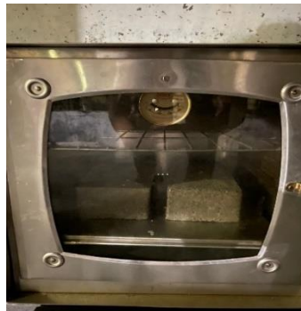
Gambar 4.13 Pengeringan menggunakan oven
