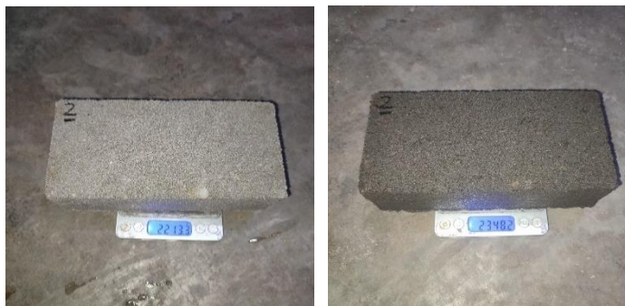
Gambar 4.29 hasil pengujian serap air sampel 2(1)
