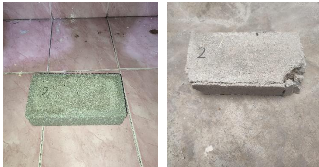
Gambar 4.21 Sampel 2(2) sebelum dan sesudah di Uji Tekan
