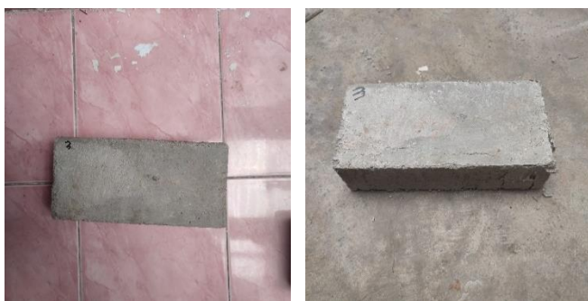
Gambar 4.24 Sampel 3(2) sebelum dan sesudah di Uji Tekan
