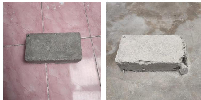
Gambar 4.20 Sampel 2(1) sebelum dan sesudah di Uji Tekan
