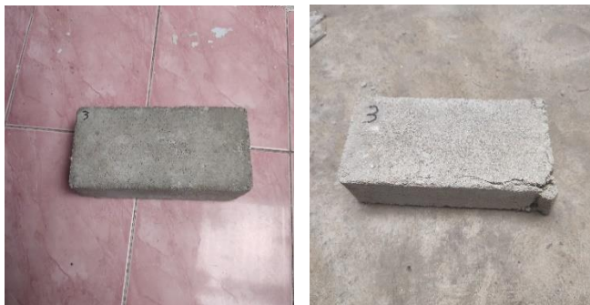
Gambar 4.23 Sampel 3(1) sebelum dan sesudah di Uji Tekan
