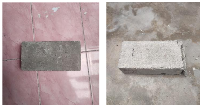
Gambar 4.18 sampel 1(2) sebelum dan sesudah di Uji Tekan
