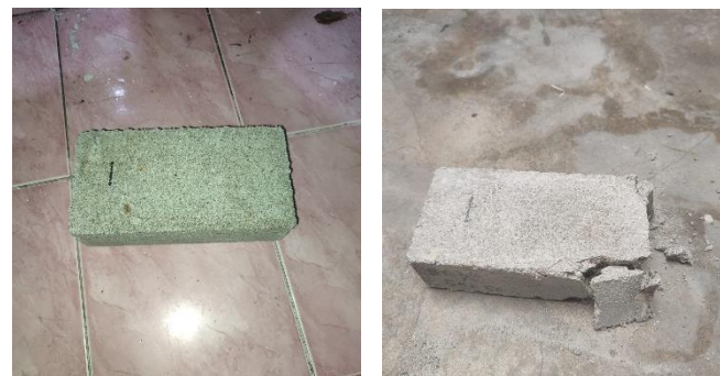
Gambar 4.19 sampel 1(3) sebelum dan sesudah di uji tekan
