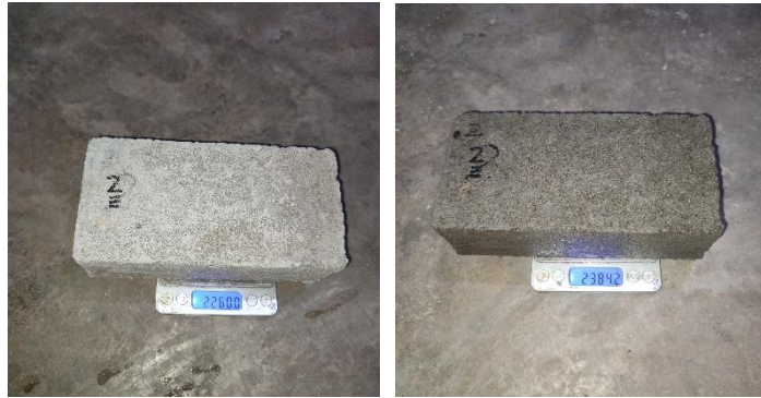
Gambar 4.31 hasil pengujian serap air Sampel 2(3)
