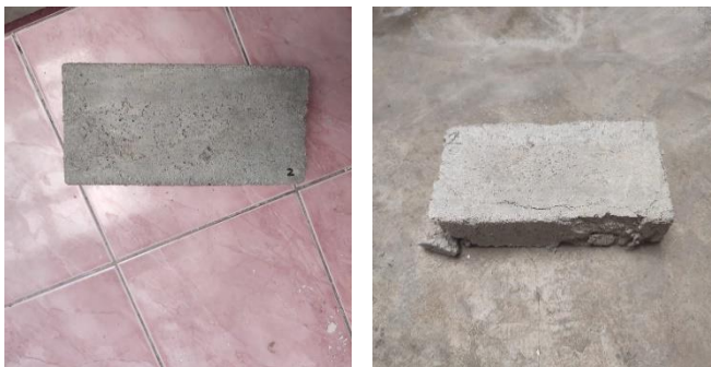
Gambar 4.22 Sampel 2(3) sebelum dan sesudah di Uji Tekan
