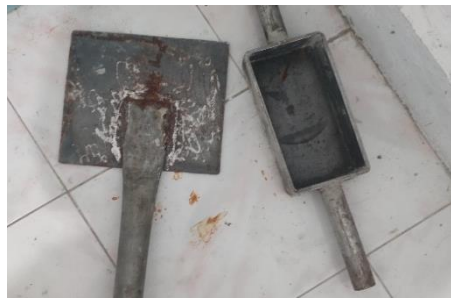
Gambar 3.3 Cetakan Paving block
