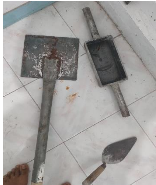
gambar 4.4 alat pembuat paving block
