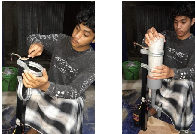
Gambar 4.9 Melakukan Pemasangan Clamp dan Baut
