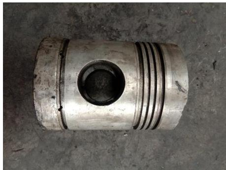
Gambar 2. 9 Torak (*Piston*) Mesin *Diesel*
