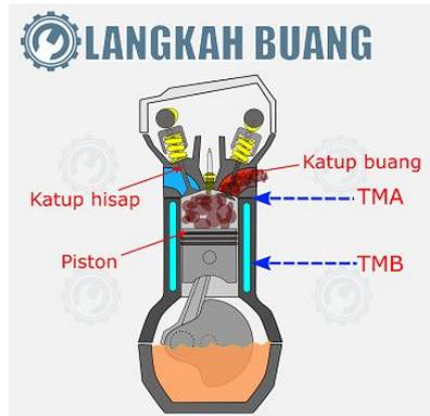
Gambar 2. 4 Proses Langkah Buang
