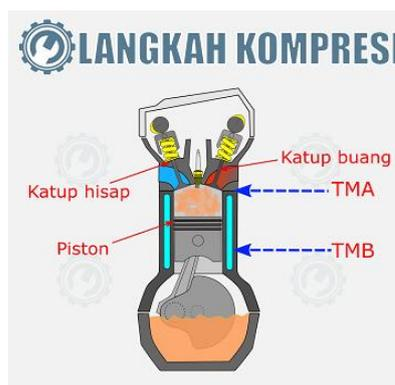
Gambar 2. 2 Proses Langkah Kompresi
