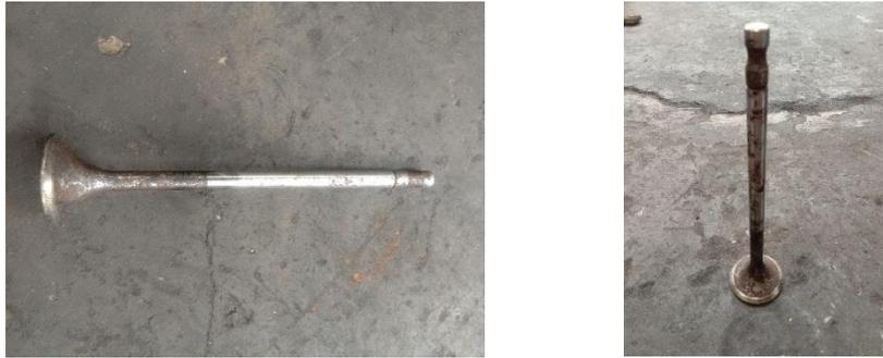
Gambar 2. 8 Katup (*Valve*) Mesin *Diesel*
