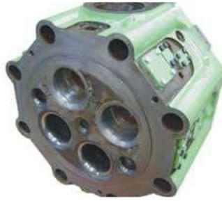
Gambar 2. 7 *Cylinder Head* Mesin *Diesel*
