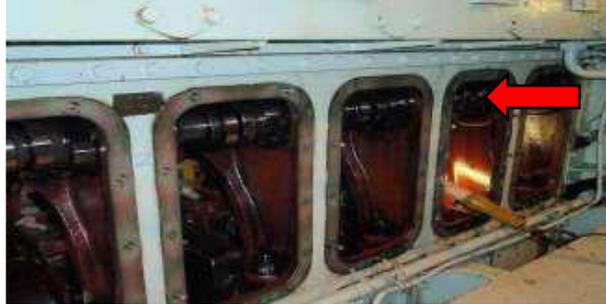
Gambar 2. 12 Poros Nok (*Cam Shaft*) Mesin *Diesel*
