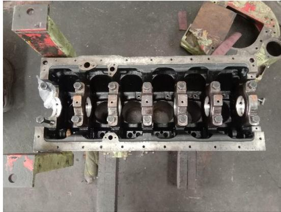
Gambar 2. 6 *Cylinder Blok Mesin Diesel*
