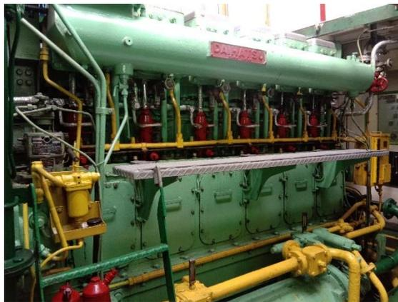
Gambar 2. 5 Mesin *Diesel* 4 Tak Pada *Tug Boat*
