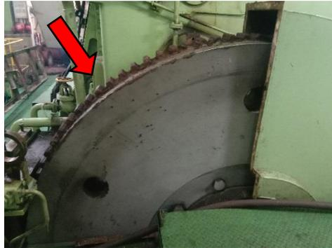
Gambar 2. 13 Roda Gila (*Fly Wheel*) Mesin *Diesel*
