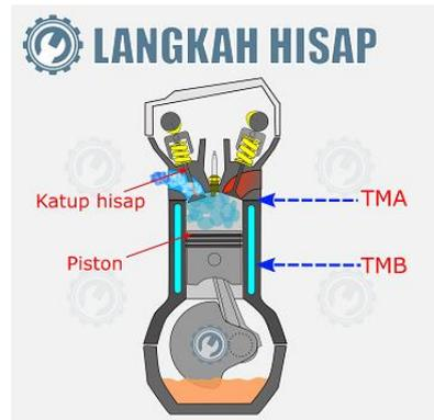
Gambar 2. 1 Proses Langkah Isap
