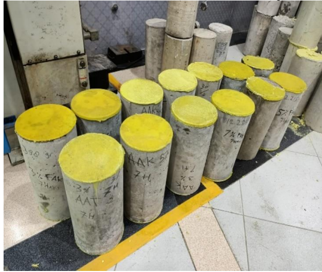
Gambar L- 7: Pembuatan Capping Untuk Pengujian Kuat Tekan Beton
