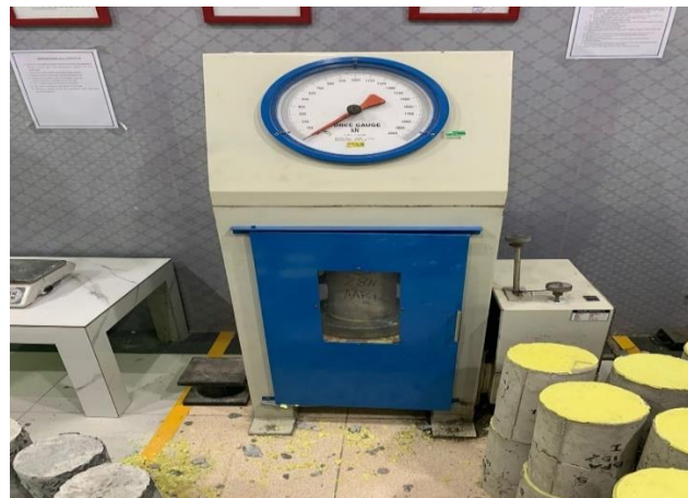
Gambar L- 9: Pengujian Kuat Tekan Beton
