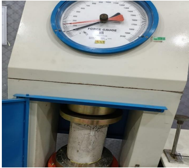
Gambar L- 10: Kehancuran Beda Uji Setelah Pengujian
