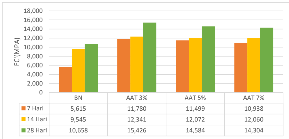
Gambar 4.10 Grafik Semua Pengujian Kuat Tekan Beton.
