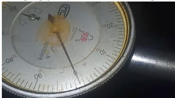
Gambar 4.1 Hasil Deflection cylinder nomor 1 Pada Posisi Bottom Portside ( Bawah Kiri) 0 mm
