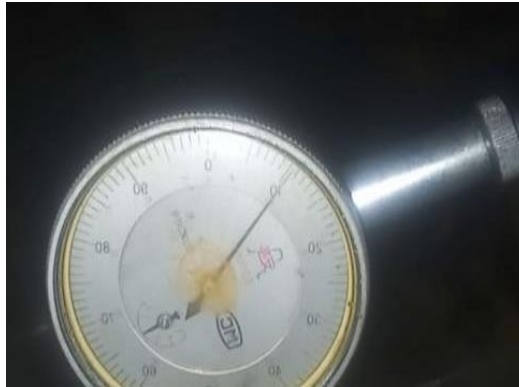
Gambar 4.4 Hasil Deflection cylinder nomor 1 Pada staboard Kanan -0.01 mm
