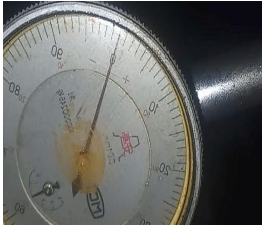
Gambar 4.6 Hasil Deflection cylinder nomor 1 Pada Posisi Bottom Portside ( Bawah Kiri) 0 mm
