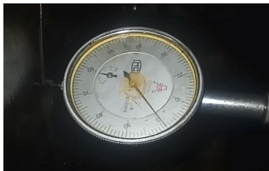
Gambar 4.2 Hasil Deflection cylinder nomor 1 Pada Posisi Portside (Kiri) 0.01 mm
