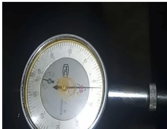
Gambar 4.5 Hasil Deflection cylinder nomor 1 Pada Bottom Staboard ( Bawah Kanan ) -0.03 mm
