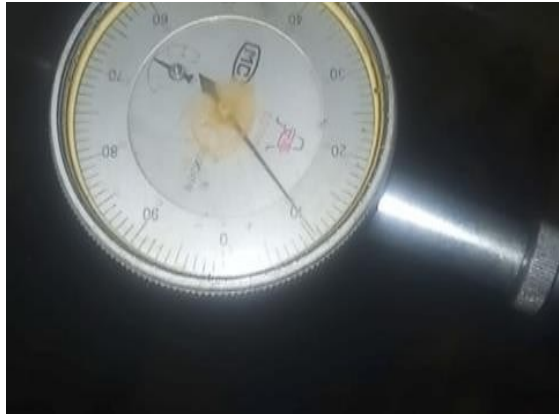
Gambar 4.9 Hasil Deflection cylinder nomor 1 Pada stboard ( Kanan ) 0.1 mm
