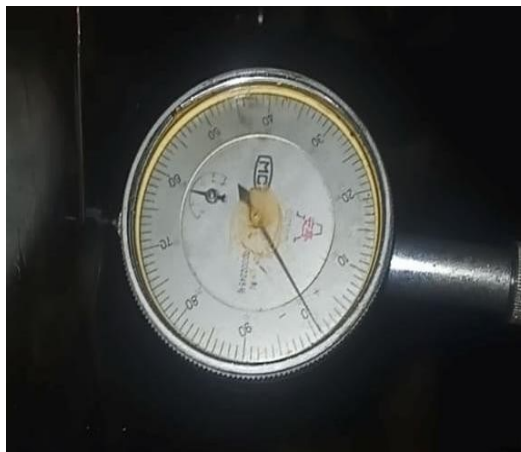
Gambar 4.7 Hasil Deflection cylinder nomor 1 Pada Posisi Portside (Kiri) 0.01 mm
