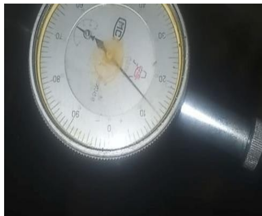
Gambar 4.8 Hasil Deflection cylinder nomor 1 Pada Top (Atas) 0.13 mm
