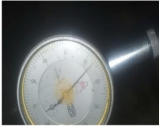
Gambar 4.3 Hasil Deflection cylinder nomor 1 Pada Top (Atas) 0.13 mm
