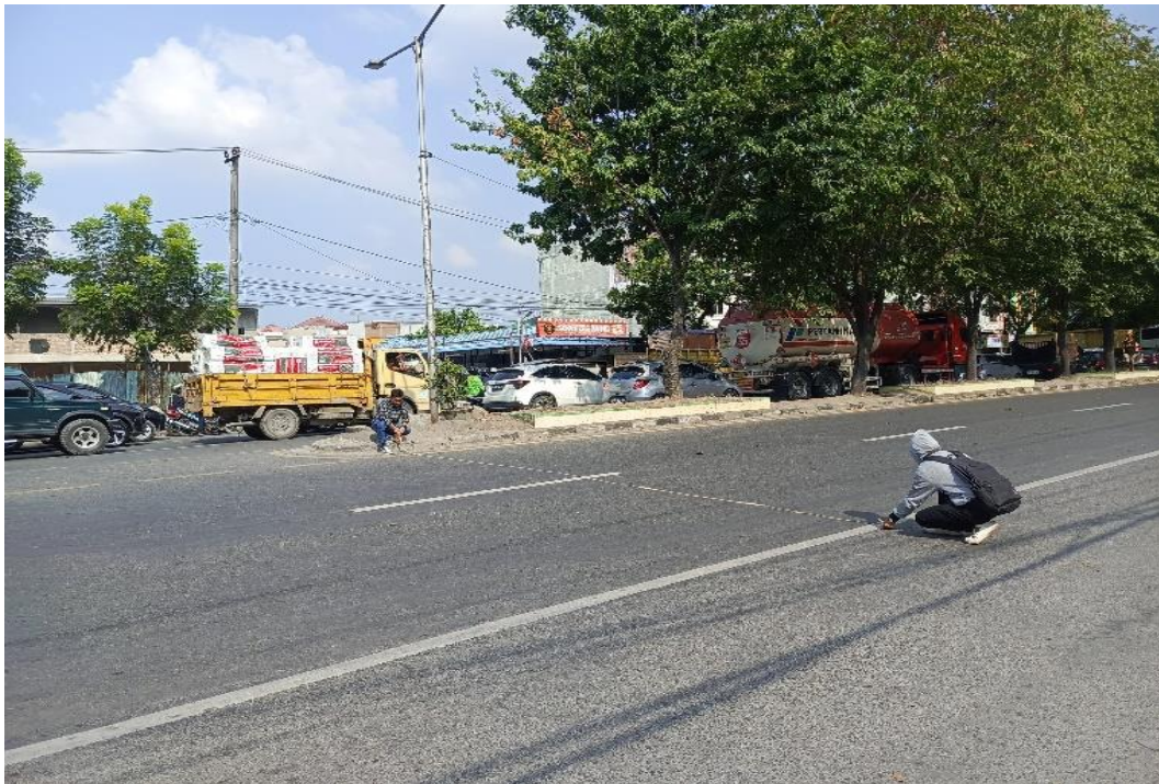
Gambar L.4: Pengukuran Lebar Jalan
