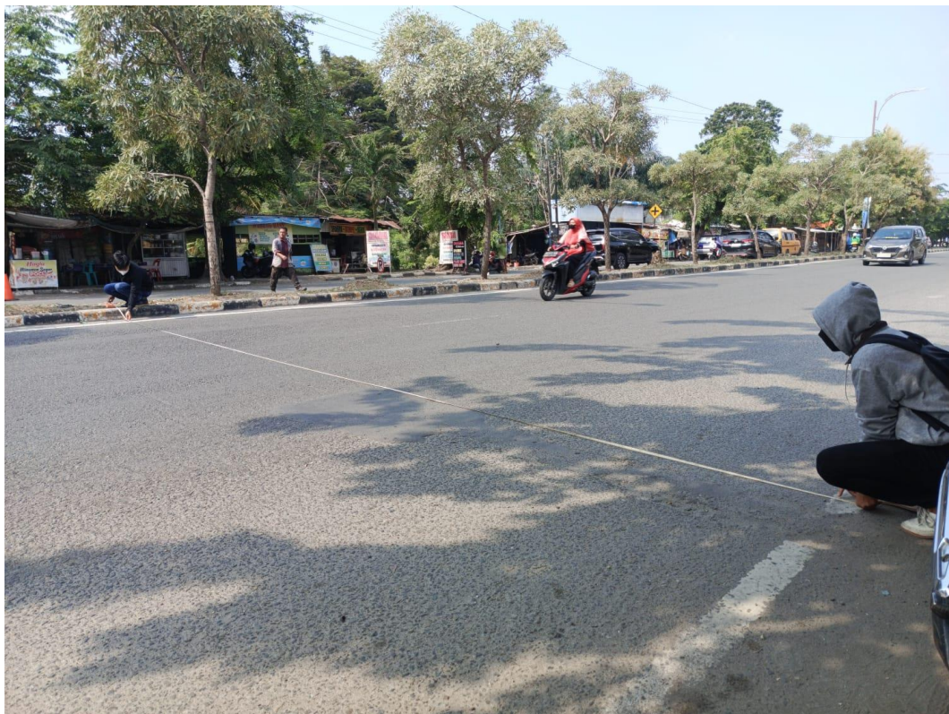
Gambar L 3 : Dokumentasi mengukur lebar jalan
