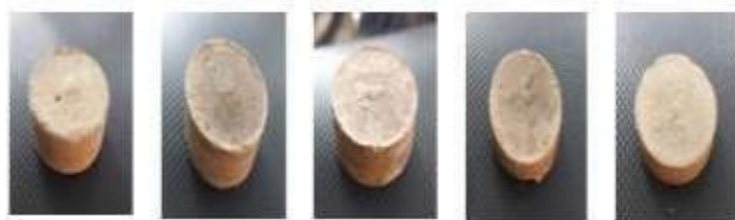
Gambar 2.9 komposit dengan komposisi styrofoam:serbuk ijuk aren(Aprilina Purbasari,dkk,2019)
