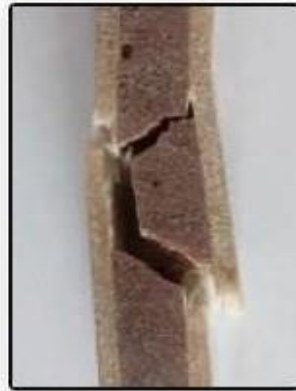
Gambar 2.7 Komposit Serat Daun Nanas Dan Serbuk Gergaji.(Alfikri Hidayat, dkk, 2016)
