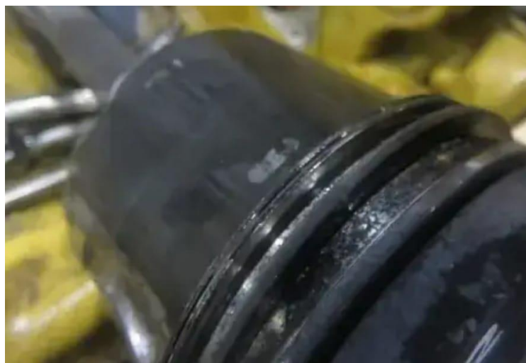
Gambar 4.7 keausan pada Piston
