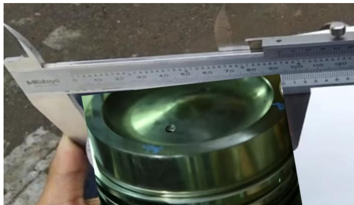
Gambar 4.1 Hasil Pengukuran Piston no 1
