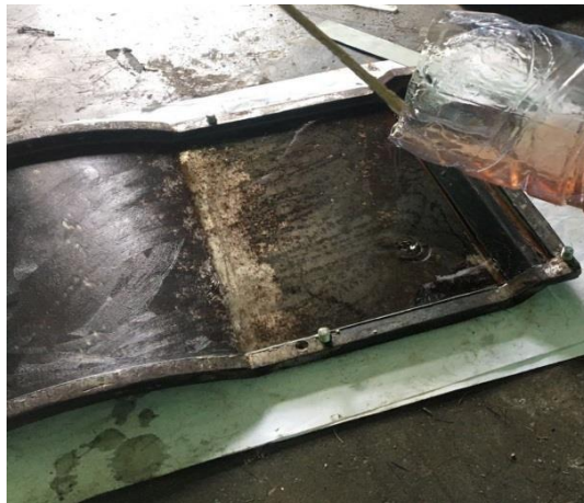
Gambar 3.40 Penuangan Resin Kedalam Cetakan Atap
