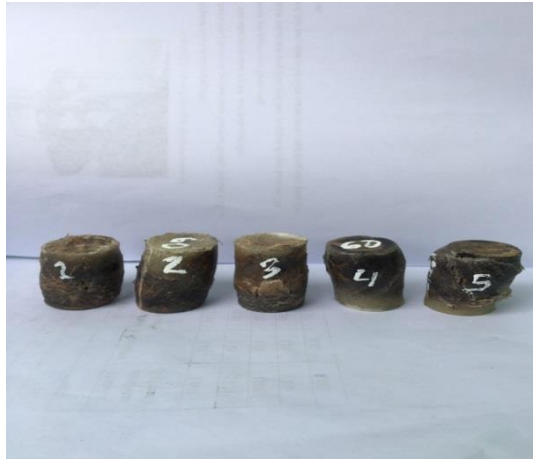
Gambar 4.2 Bentuk Spesimen Hasil Dari Pengujian Tekan 60 Gram Resin : 20 Gram Serat durian 20 Gram Serat tankos
