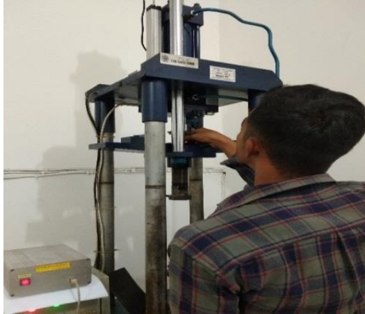
Gambar 3.46 Proses Pemasangan Spesimen compress
