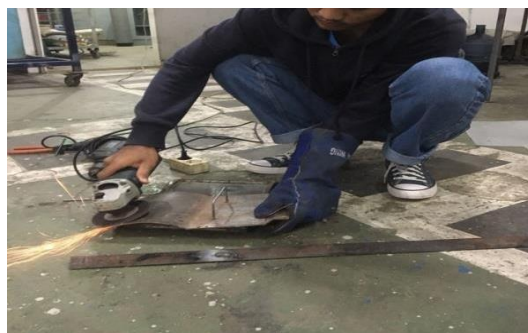
Gambar 3.32 Proses Pengalusan Permukaan
