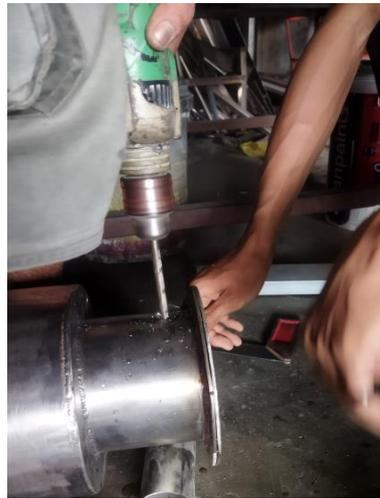
Gambar 4.14 Proses pengeboran saluran penghubung
