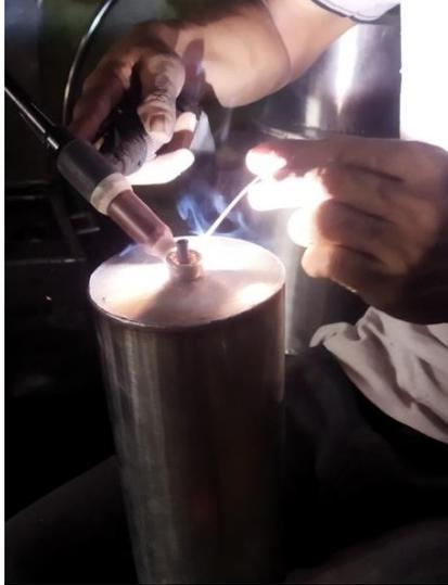
Gambar 4.20 Proses pengelasan tutup, pipa spiral, derat mur pada kondensor
