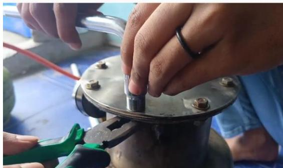
Gambar 4.30 Proses pengencangan tutup reaktor
