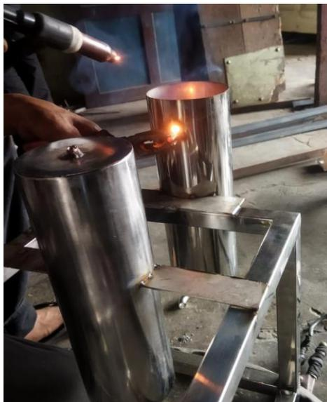
Gambar 4.23 Proses pengelasan nepel
