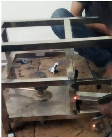
Gambar 4.9 Pengelasan dinding kompor
