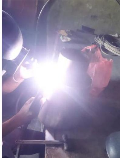
Gambar 4.10 Proses pengelasan tabung reaktor
