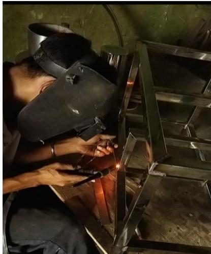
Gambar 4.3 Proses Pengelasan Rangka
