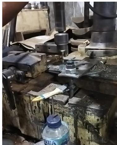
Gambar 4.13 Proses pengeboran tutup reaktor
