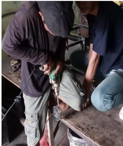
Gambar 4.18 Proses pengeboran tabung kondensor dan penampung air
