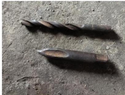
Gambar 3.28 *Drill Bit* dan *Hole Punch*
