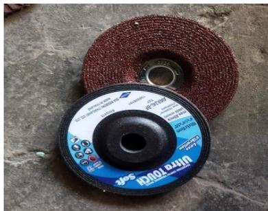
Gambar 3.25 *Fibre Disc*
