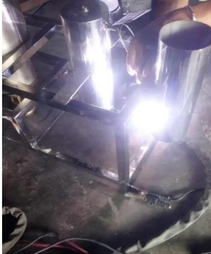
Gambar 4.22 Pengelasan tabung penampung air
