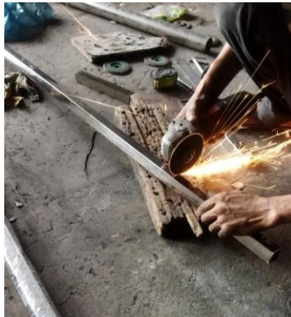
Gambar 4.1 Pemotongan *Stainless Stell Hollow*
