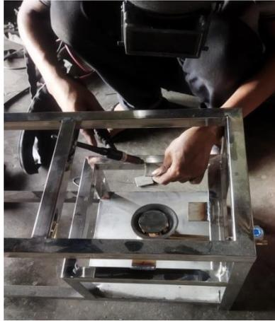
Gambar 4.7 Proses pembuatan Dudukan reaktor
