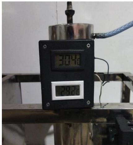
Gambar 4.27 Kotak Termometer suhu air
