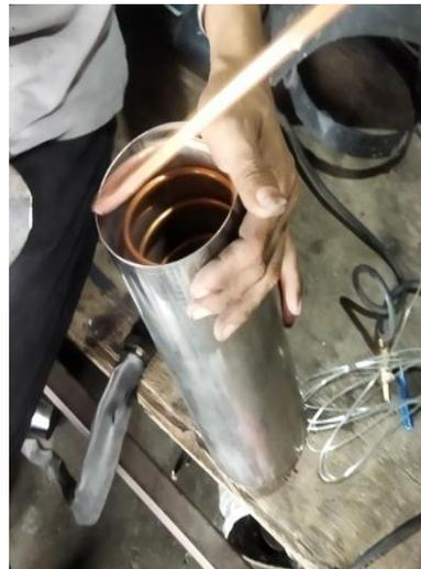
Gambar 4.19 Memasukkan spiral pada tabung kondensor
