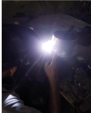
Gambar 4.12 Proses pengelasan derat
