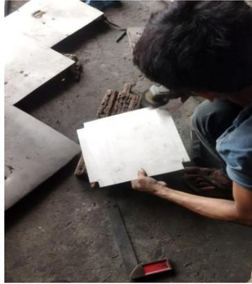
Gambar 4.4 Proses Pembuatan Alas Tungku
