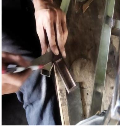
Gambar 4.2 Proses Pemotongan Sudut *Stainless Steel Hollow*
