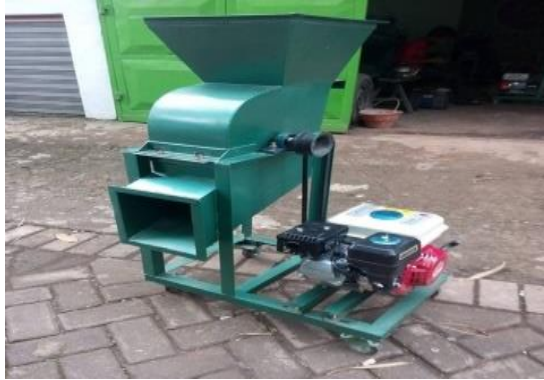
Gambar 2.3 Mesin Pencacah Jerami Padi (Alfajar, 2019)
