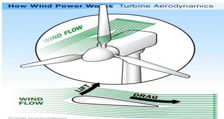
Gambar 8b. Penampakan arah angin pada turbi
