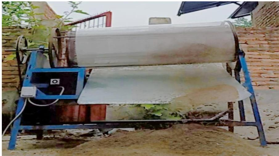
Gambar 4.23 Hasil *Assembly* Mesin Pengayak
