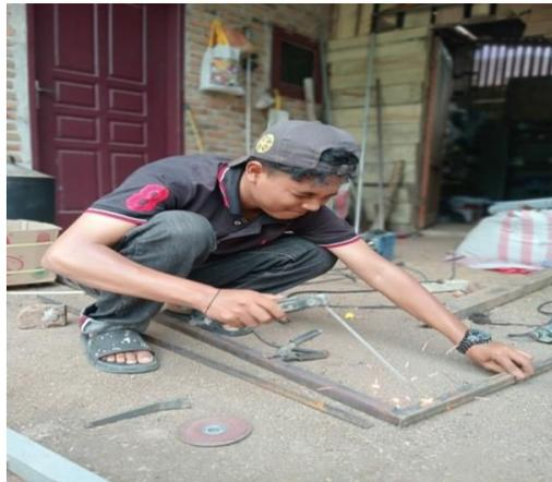
Gambar 4. 3 Proses Pengelasan
