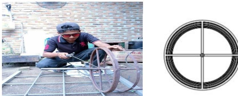
Gambar 4. 5 Pengelasan As pada Rangka pengayak
