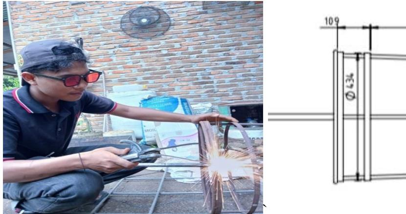
Gambar 4. 6 Mengelas Sambungan diameter rangka saringan
