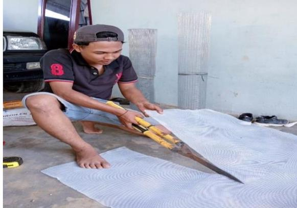
Gambar 4. 8 Proses pemotongan jaring kawat
