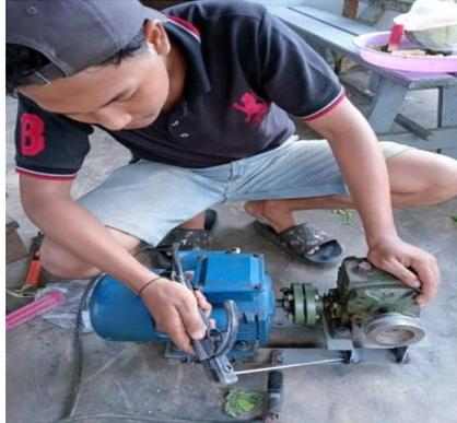
Gambar 4. 18 Proses pengelasan pada dudukan mesin penggerak
