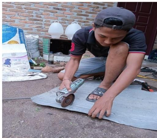
Gambar 4. 11 Proses Pemotongan Seng plat alumunium
