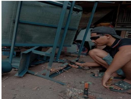
Gambar 4. 19 Pengelasan pada tapak dudukan dynamo dan gearbok
