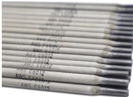
Gambar 3. 23 Kawat Las (*Elektroda*)
