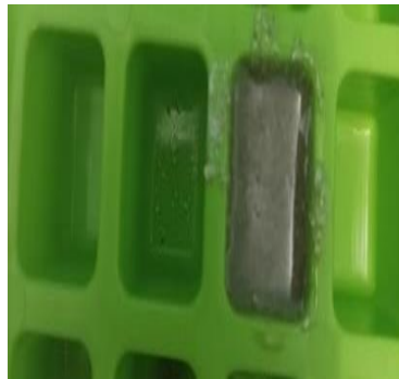
Gambar 4.22 proses pencetakan spesimen uji lentur
