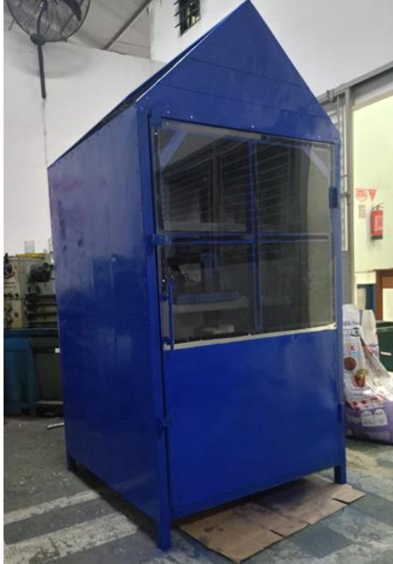
Gambar 3.6 Alat penelitian pengering bawang merah (Nasution, Chandra, dan Aulia 2023)
