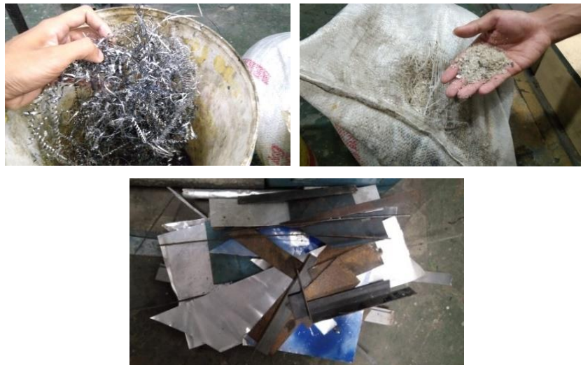
Gambar 2.7 Absorber geram besi dan pasir pantai (Nasution, Chandra, dan Aulia 2023)
